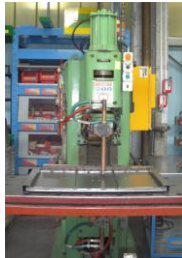
1 LANGUEPIN 180 KVA 50% 335 KVA maximal
