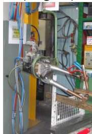
1 ARO 31 KVA (tragbar)
